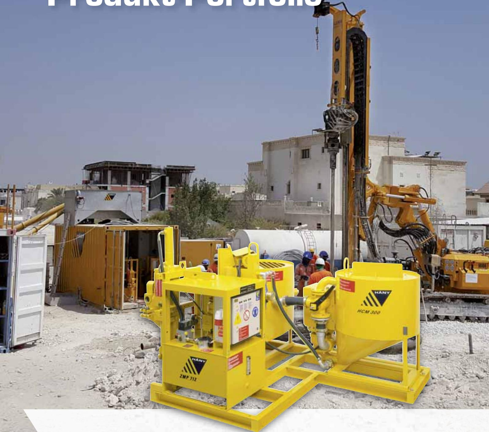
Misch- und Injektionsanlagen für die Bodenverbesserung, Verankerung, Bewehrung, Abdichtung, Rohrvortrieb, Mikrotunnelbau und Richtbohren.
