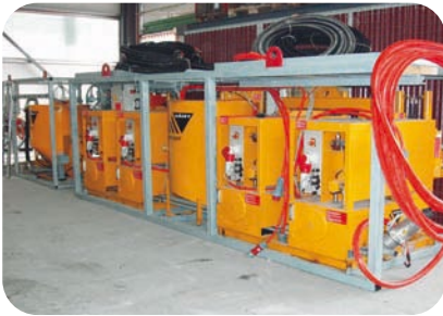
Anlage IC 1400/820 mit 4 Injektionspumpen IC 1400/820 plant with 4 grout pumps
